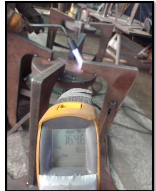
Fig.1: Precalentamiento del material
