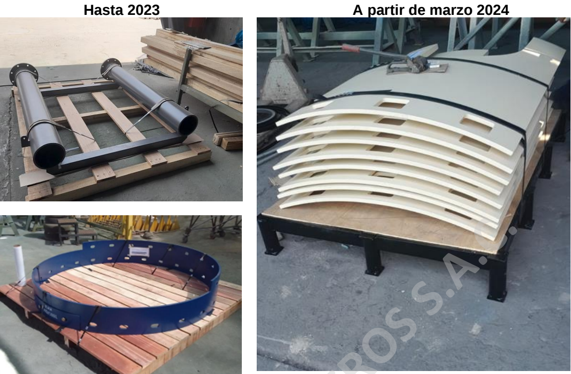
Figura 18. Cambio en la fabricación de embalajes de madera a acero.
