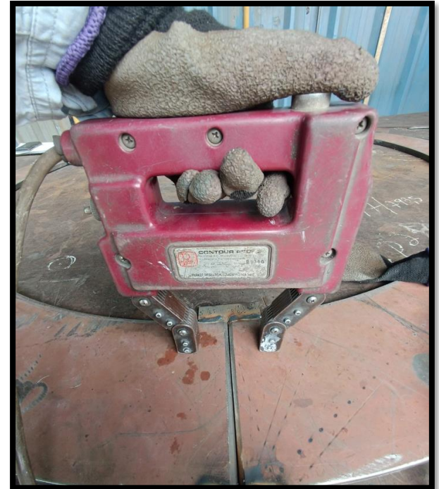
Fig.2: Desmagnetización del material anti abrasivo con el Yugo Magnético
