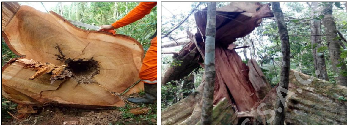
Figura 2. Defectos comunes en patio de trozas : Huecos o rajaduras a causa de una mala dirección de caída. Obtenido de "Determinación del coeficiente de conversión del árbol en pie a troza en patio del aserradero, de la especie shihuahuaco ( dipteryx spp. )" por Valencia [3]
