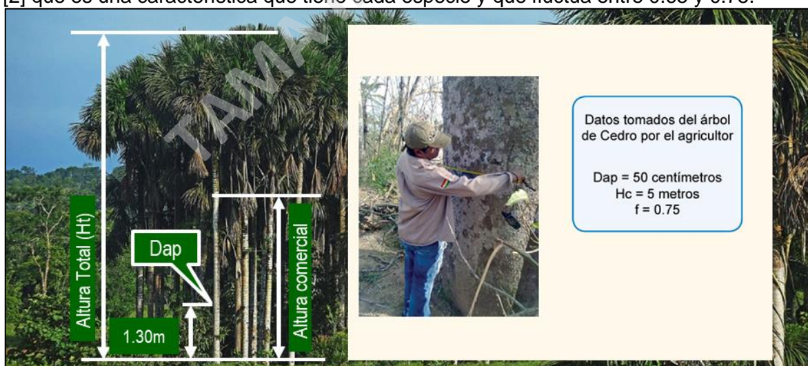
Figura 1. Medidas de un árbol en pie. Fondo: Palcazú, provincia de Oxapampa, departamento de Pasco.
