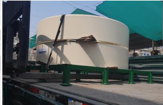
Figura 18. Diseño de parihuelas metálicas con acero sobrante.
